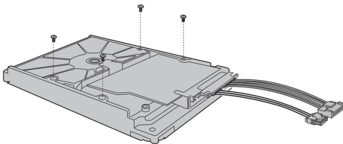
2. 打开机箱上盖，再将硬盘上的螺丝对准机箱底部预留孔，推动硬盘至固定位置。
